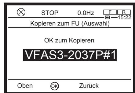
(5) Nach erfolgreichem Abschluss des Kopiervorgangs wird der CRC-Prüfcode angezeigt.
