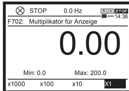
■ Die Anzeige der Ausgangsfrequenz in der [Monitorebene] und der Parameter Einstellwerte kann in die Motordrehzahl oder die Lastgeschwindigkeit umgerechnet werden.
