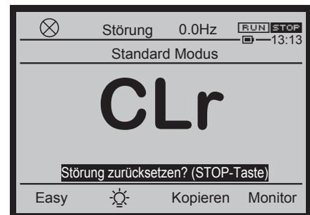
2) Drücken Sie, während "CLr" blinkt, die Taste [STOP/RESET] nochmals. Die Störung wird zurückgesetzt, die Anzeige wechselt in den Standard-Modus und die Hintergrundfarbe wechselt nach weiß.
