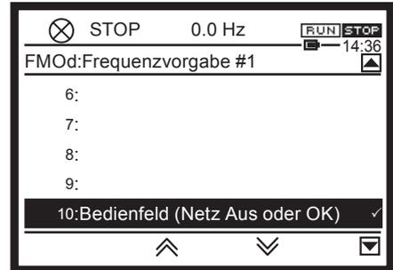
Die Anzeige wechselt zurück zur Liste der Basisparameter. Der am rechten Rand angezeigte Wert des Parameters <FMOd> sollte jetzt "10" sein.
